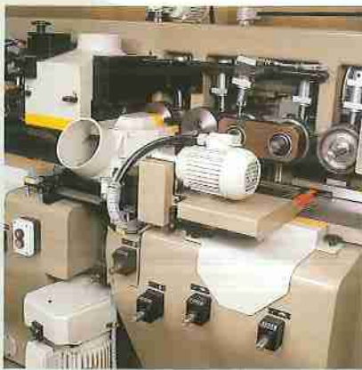
1) Zona entrata macchina, in evidenza lettori decimali Machine's infceed (detail of decimal readouts) Entrée de la machine, en évidence les lecteurs décimales. Maschineneinlauf, Besonderheit Dezimal-Anzeige Входная зона станка, на первом плане десятичные счетчики
